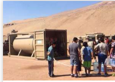
CONTENEDOR ALJIBE AGUA
